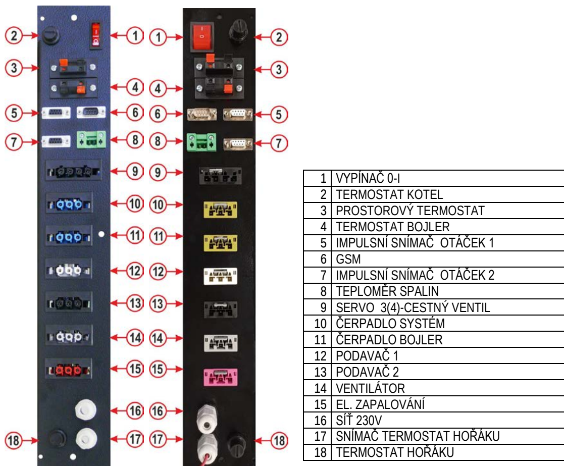
Obr. č. 5 Řídicí jednotka – přípojný panel s konektory varianta 1, varianta 2
